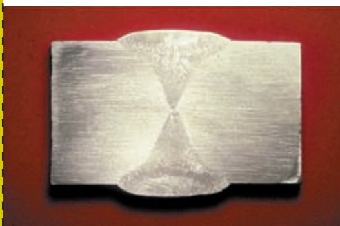
Arcal 1 I = 400 A U = 35,5 V szybkość: 22 cm/min
